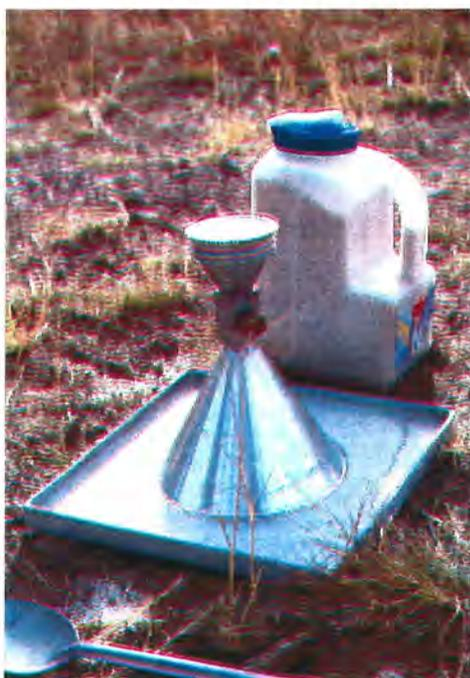
**Figure 3.3. Sand-cone apparatus.**
